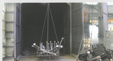
7. Shot blasting ショット
