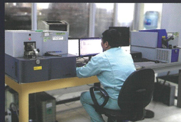
3. Optical analyzer 発光分光分析装置
