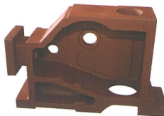
Name : Housing Material : FC 250 Weight : 105 kgs
